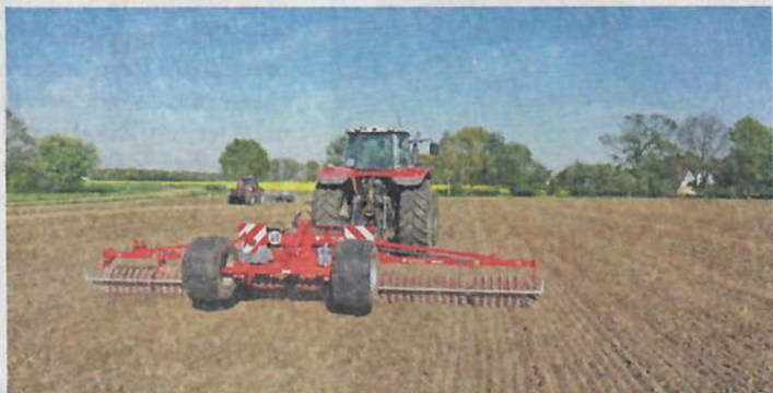
Die Güttler Prismenwalzen schaffen ein ideales falsches Saatbett. Sie festigen den Saathorizont, schaffen dort feine Erde mit genügend Feuchtigkeit für optimale Keimbedingungen.
