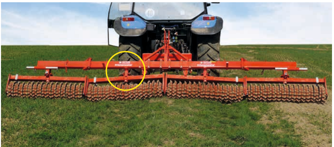
Mediana 600 - Vier pendelnde Walzensektionen, unübertroffene Boden Anpassung.
