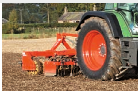
DX 30-56 mit Zinkenvorsatz und Heck-Dreipunkturm zur Saatbettbereitung
