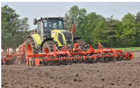
Avant SX 610-56 U mit Zinkenvorsatz zur Maissaat
