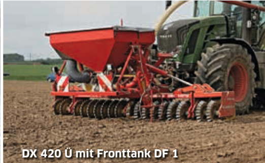
Mit Heck-Dreipunkturm zur Saatbettbereitung
