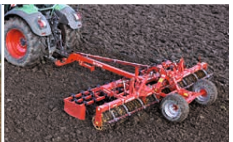
Avant SX 610-56 U mit Zinkenvorsatz, Zugdeichsel und Fahrwerk (nachrüstbar)
