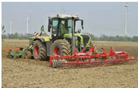
Avant SX 610-56 U mit Einebnungs- striegel zur Maissaat
