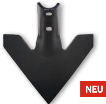
Das neue Super Maxx® Gänsefuß-Schar 200 mit 70 mm Überschnitt.
