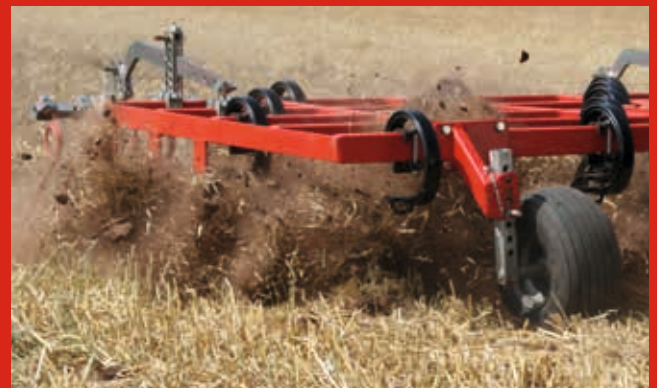
Die aggressiven Federzinken ziehen sich selbst in den Boden ein, unabhängig vom Gewicht des Geräts.
