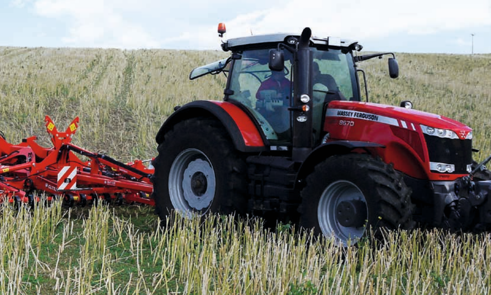
Super Maxx® 1200-7 BIO: Rapsstoppel "ankratzen" und Ausfallraps zum Keimen anregen und beim nächsten Arbeitsgang bekämpfen.
