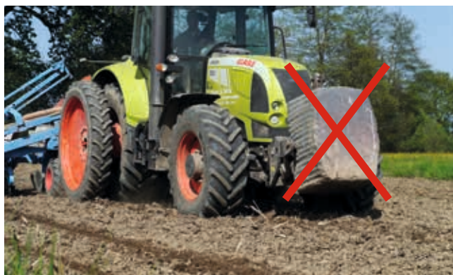
Toter Frontballast – kopflastiger Schlepper: Bodenverdichtungen durch die stark belastete Vorderachse.
