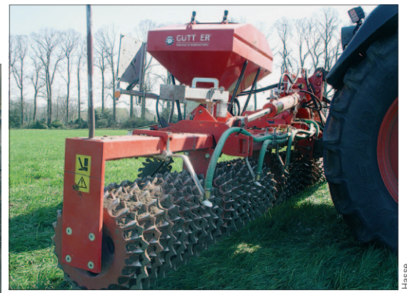
Aufgesattelt auf der Walze befindet sich das Säaggregat. Das Saatgut fällt über die schräg gestellten Prallteller direkt vor die Walze.
