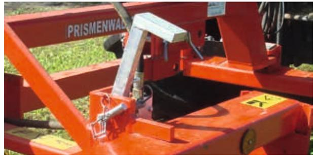
Zum Ausklappen müssen diese Fallriegel ganz nach oben geklappt und in geöffneter Stellung durch den Sicherungsbolzen gesichert werden. Die Absperrhähne für die Klappzylinder sind jetzt geöffnet und die Walzensegmente können ausgeklappt werden.
