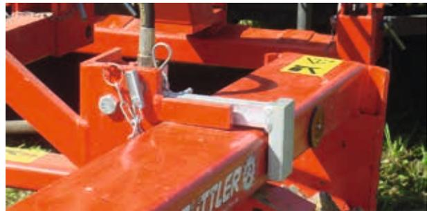
Nach dem Einklappen der Walzensegmente müssen die Fallriegel wieder geschlossen und mit den Sicherungsbolzen gesichert werden.
