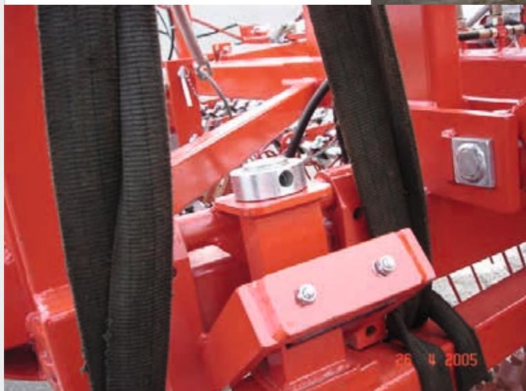
Bringen Sie den Verschlussring an und sichern Sie diesen mit der Sechskantschraube M16 mit Sicherungsmutter.
