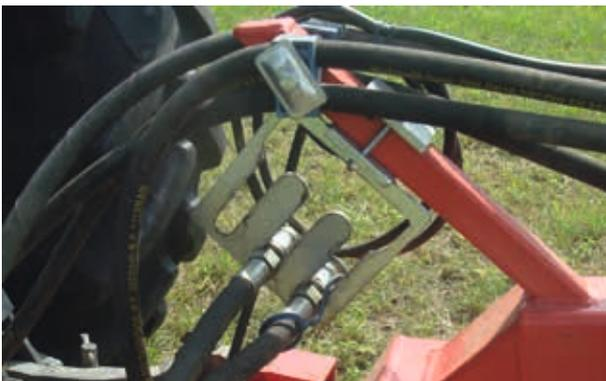
2. Öffnen Sie den Absperrhahn am rot markierten Hydraulikschlauch.
