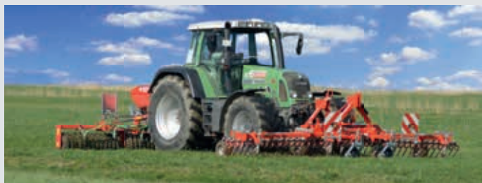
Striegeln, säen und walzen in einem Arbeitsgang
