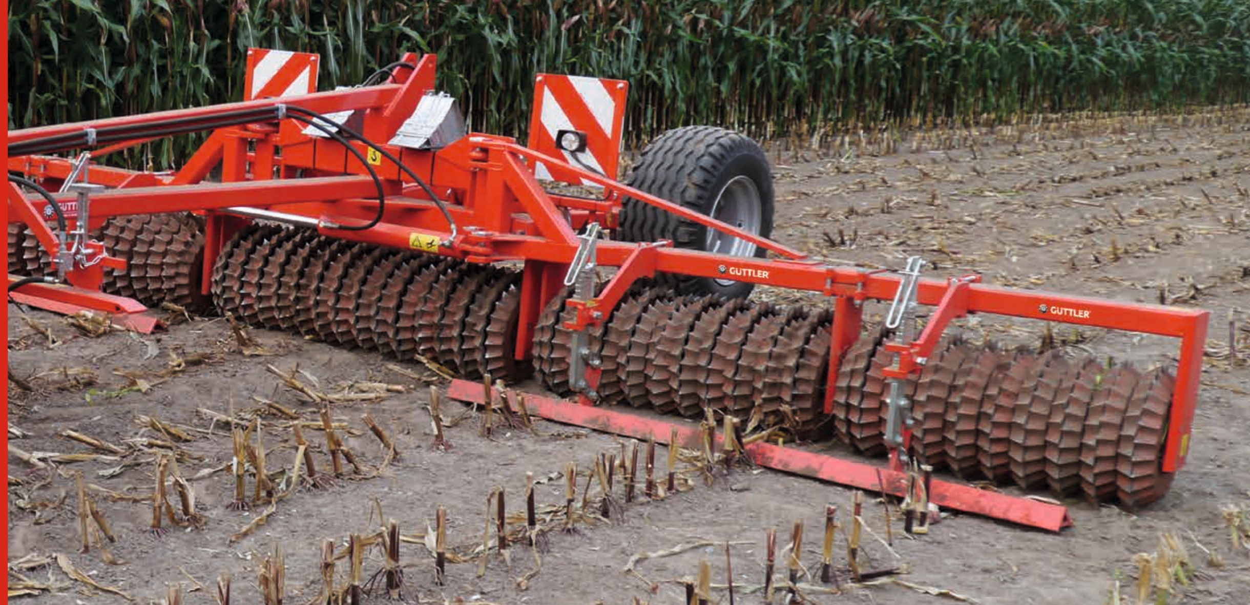
Maisstoppeln anschlagen, quetschen oder brechen: Die Stoppeln gehen schneller in die Rotte, der Maiszünsler kann nicht überwintern!
