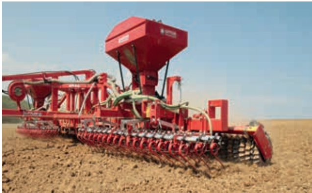
Auf Wunsch lassen sich zwei Säegeräte à 410 Liter Tankinhalt aufbauen (hydraulisches Gebläse)
