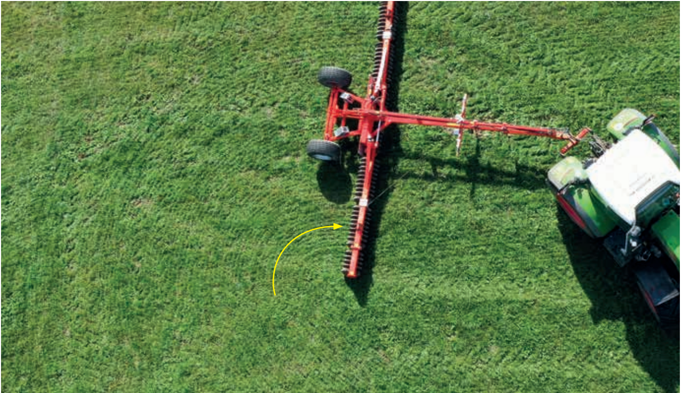
Besonders wichtig auf Grünland: Enges Wenden ohne schädliches Radieren, da alle Walzensterne in einer Flucht angeordnet sind!
