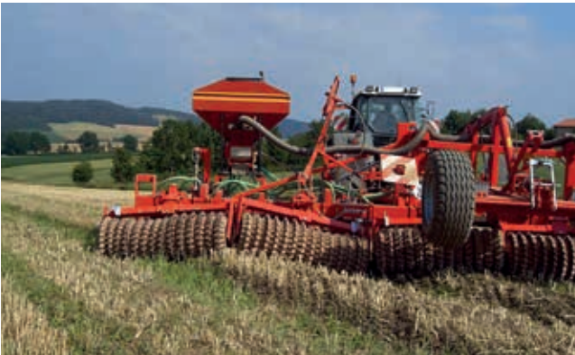
Auf Wunsch lassen sich zwei Säegeräte à 410 Liter Tankinhalt aufbauen (hydraulisches Gebläse)
