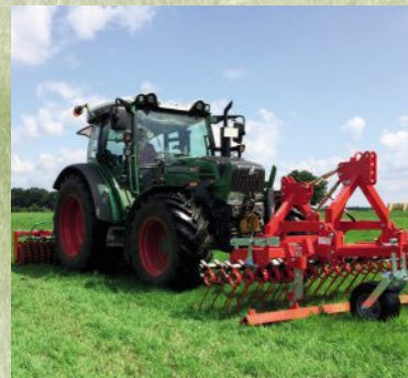
GreenMaster ALPIN Front-, Heck-Kombi mit Striegel, Walze und Sägerät
