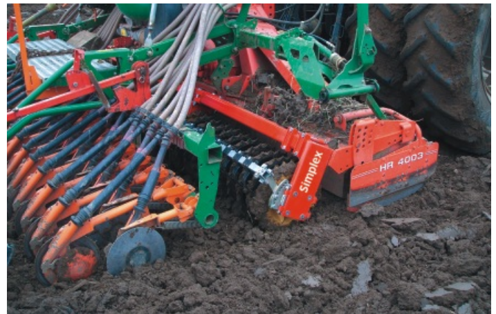
SX 41 (Durchmesser 45 cm) Synthetik Ultra mit Aufbaudrille, Arbeitsbreite 4,00 Meter
